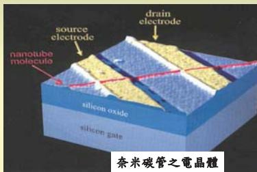
◆ 應用碳奈米管當電晶體的通道介質，配合top-gate技術，發展出製程簡單、穩定且能與目前半導體製程整合的碳奈米管場效電晶體(CNT-FET)製作技術，已完成on/off ratio>105的P型碳奈米管電晶體及N型碳奈米管電晶體製作、碳奈米管NOT邏輯元件之量測等。
